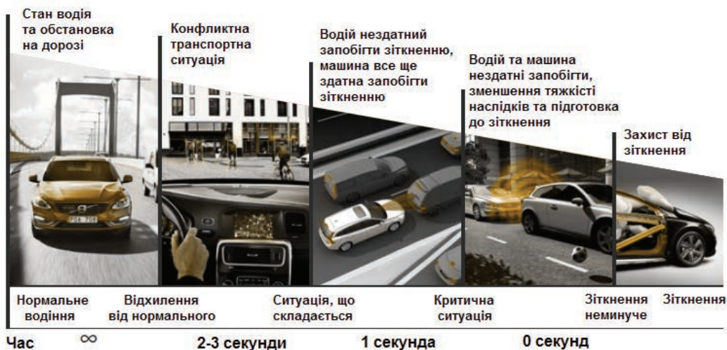
Рис. 16 - Алгоритм роботи сучасної системи безпеки автомобілю Volvo на базі “цілісного підходу”
